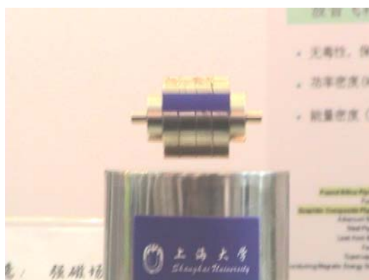
图1 上海大学高温超导磁悬浮轴承演示装置 研究 [16,17] ,为进一步研究高温超导磁悬浮轴承-转子系统的动力学特性打下了基础。
